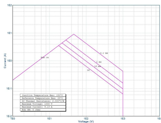
图 6 安全工作区曲线
