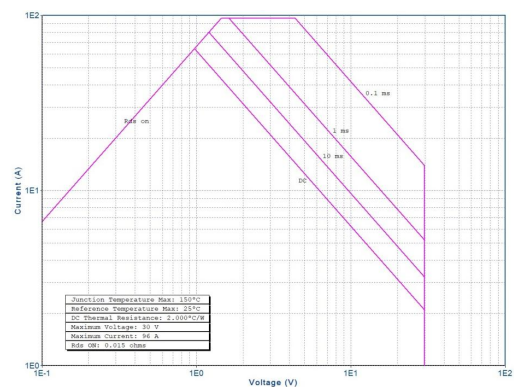
图 6 安全工作区曲线
