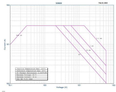
图 6 安全工作区曲线
